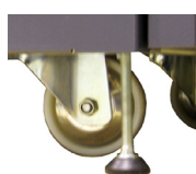
Élément ( PB ) serré contre le sol.
